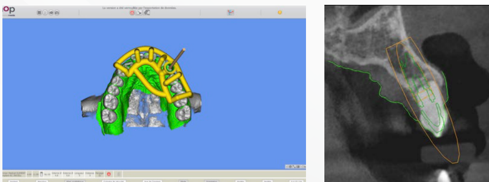
Mit der SMOP-Software entworfene Bohrschablone
