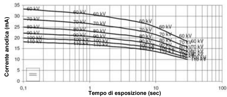
Figura 12 Emissioni del filamento del tubo radiogeno: OPX 105
